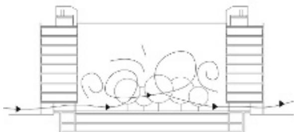
Un auténtico dispositivo climatizador, al dejar pasar el aire a través de la masa arbolada hacia las capas superiores del interior del patio, a lo que coadyuva la permanencia en sombra de la lámina arbolada, de menor temperatura.
